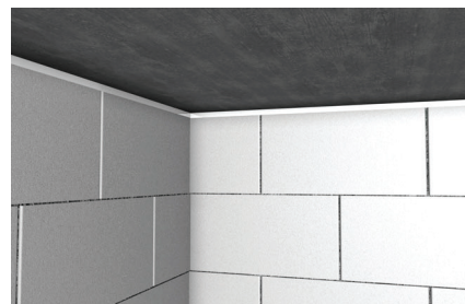
Falszerkezet felső csatlakozásai
