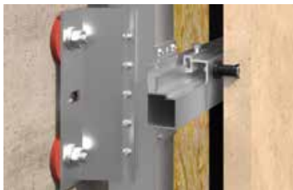
A SystemOne homlokzati rendszer keresztmetszete terméskő panellal
