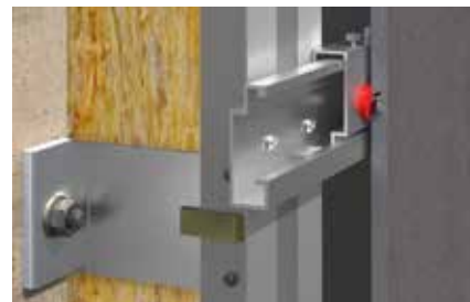
Homlokzat keresztmetszet Tergo+ dübellel
