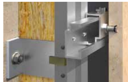
Homlokzat keresztmetszete távtartószerelésnél
