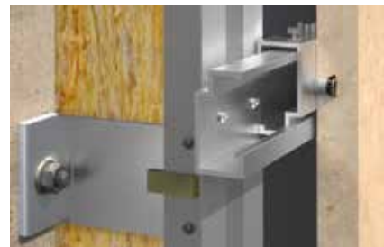
Homlokzat keresztmetszet belsőmenetes horgonnyal
