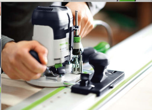
Egyenes marás a felületen – a vezetősín ideális hátlap-horony marásakor a felületen.
